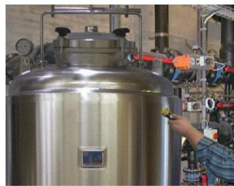
*Регистрация разгерметизации резервуара с помощью флуоресцентного концентрата H 849*
