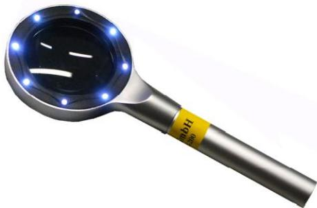
Лупа с 2,5-кратным увеличением. Экономичная неслепящая подсветка с двумя режимами на 8 светодиодах. Линза из оптического стекла Ø 55 мм. Металлический корпус.
