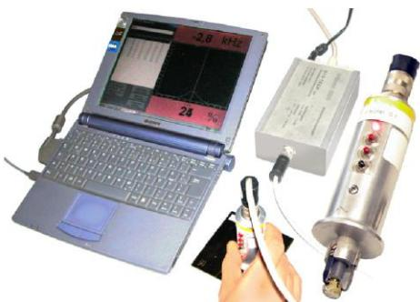
Измерительный прибор, в основу которого положен принцип ультразвукового резонанса, предназначен для проверки и количественной оценки качества проклейки листовых конструкций (алюминий, сталь, композитные материалы)
