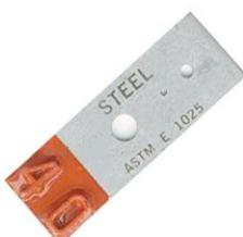
Пенетрометры из железа и легированной стали применяются для всех ферритовых и аустенитных сталей. Свинцовые цифры на образце обозначают номер penetromетра, который также соответствует толщине образца в тысячных долях дюйма. Каждый образец имеет три отверстия, диаметр которых равен 4x, 1x или 2x-кратной толщине образца. Однако наименьшие диаметры не должны быть менее 0,04 – 0,01 – 0,02 дюйма, поэтому отверстия соответствующего penetromетра отличаются, начиная с номера 12.
