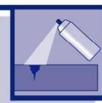
Капиллярный метод неразрушающего контроля основан на капиллярном проникновении индикаторной жидкости (пенетранта) в поверхностные дефекты (трещины, поры и пр.) с последующей регистрацией индикаторных следов визуальным способом или с помощью преобразователя. Метод капиллярного контроля позволяет обнаруживать поверхностные дефекты с раскрытием до тысячных долей миллиметра ( $\mu\text{m}$ ) независимо от вида, материала и конфигурации поверхности.
