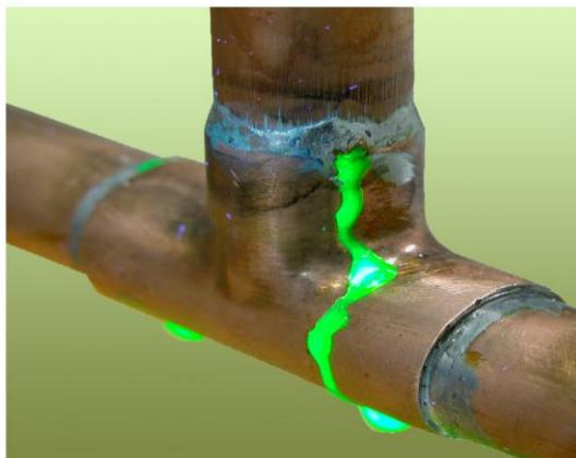
Регистрация утечки в системе охлаждения с помощью флуоресцентного концентратса
