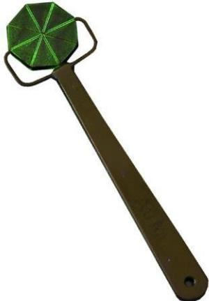
D 250 представляет собой восьмиугольный образец толщиной 3 мм, разделенный на 8 сегментов из мягкой стали. Шлицы между сегментами заполнены твердым припоем и имеют толщину максимум 0,79 мм. Одна сторона образца плакирована медью.
