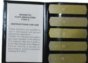
Индикаторы Burmah-Castrol представляют собой тонкие гибкие металлические полоски размером 50x12x0,15 мм. Индикаторы состоят из трех слоев, каждый толщиной 0,05 мм. Средний слой выполнен из никель-железного сплава с высокой относительной магнитной проницаемостью. Наружные слои выполнены из немагнитного материала. Средний слой имеет три продольных параллельно расположенных шлица длиной 42 мм.
