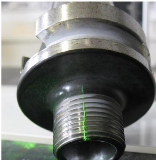
Индикация трещины, полученная при использовании водной супензии на основе концентрата Super Magna LY 1500-MP
