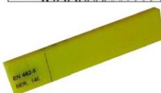
Эталон со сдвоенной проволокой (по стандарту DIN-EN462-5) предназначен для определения резкости изображения радиографических снимков и используется в сочетании с проволочными или перфорированными penetromетрами.
